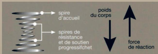
Sa force de réaction est proportionnelle à la pression exercée. Plus la pression est importante plus la réaction est tonique.
